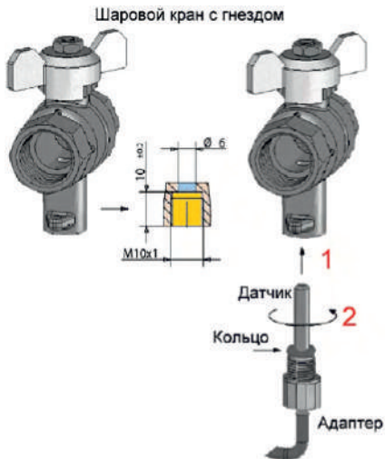
Рис. 1.5. Монтаж термодатчика в гнездо шарового крана
